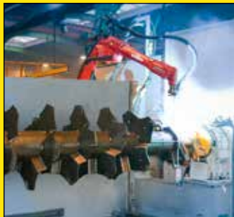
Robot de soldadura
