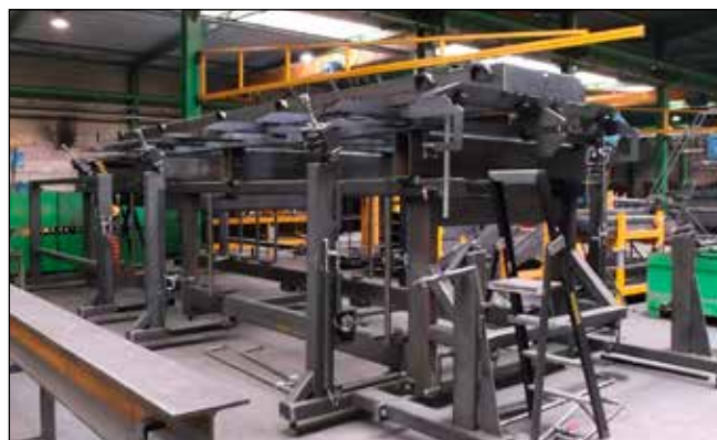
Los gálibos de fábrica garantizan precisión y rapidez de producción
