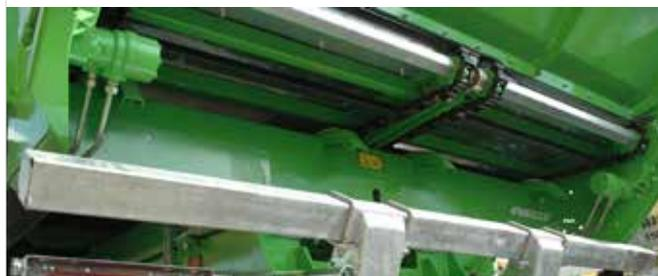
*Accionamiento del suelo por dos motores hidráulicos*
