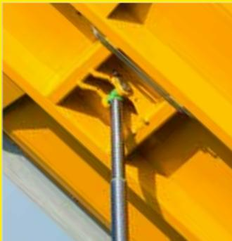
*Punto de anclaje del cilindro sobre la caja*
