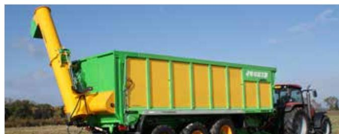
Un sistema de transbordo puede montarse sobre la puerta trasera del DRAKKAR. Dos tornillos, uno horizontal sobre todo el ancho de la caja, y el otro vertical, accionan la materia con un caudal de 450 t/h. Una segunda puerta se entrega para una utilización sin el tornillo.
