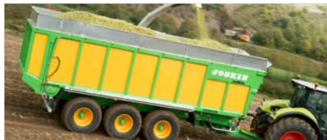
Los DRAKKAR pueden estar equipados con realces galvanizados fijos o hidráulicos. Gracias al sistema hidráulico, usted decide equipar o no su remolque con realces. El pilotaje independiente del realce izquierdo o derecho permite facilitar la carga con una ensiladora.
