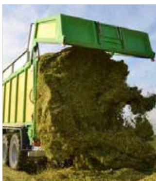
En algunos casos de utilización, es necesario abrir sólo ligeramente la puerta o dejarla cerrada y efectuar el vaciado por la(s) escotilla(s). Para eso, una caja situada en la parte trasera del vehículo le permite hacer avanzar y retroceder el suelo móvil progresivamente.
