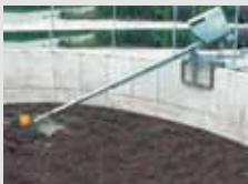
Batidoras eléctricas para fosas de estiércol abiertas y lagunas
