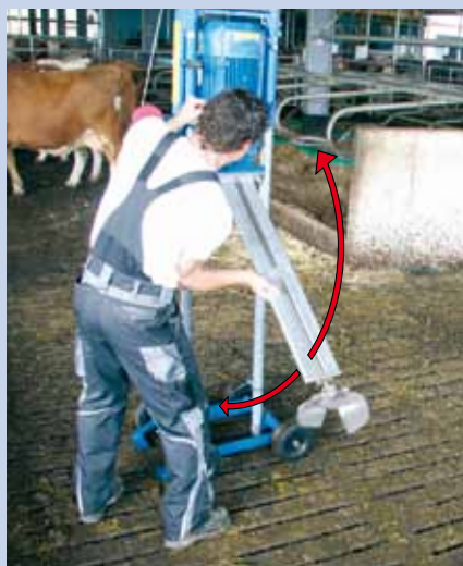
Espada de batidora de charnela plegable hacia arriba
