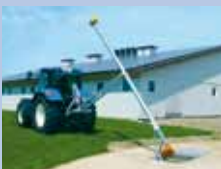
Batidora de estiércol para fosas cubiertas
