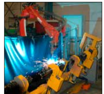
Robot de soldadura
