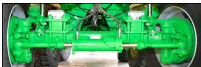
Eje direccional forzado (100 % direccional)
