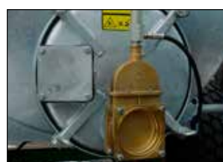
Orificio de acceso estándar ( \varnothing 600 mm)
