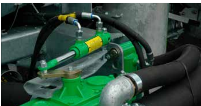
Inversor de bomba hidráulica
