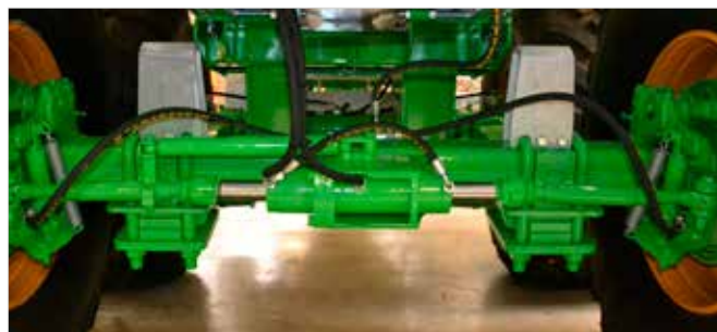
Eje seguidor (50 % direccional)
