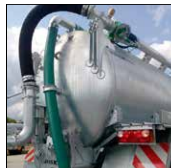
Montaje sobre la cuba (Modulo2, Volumetra y Cobra)
