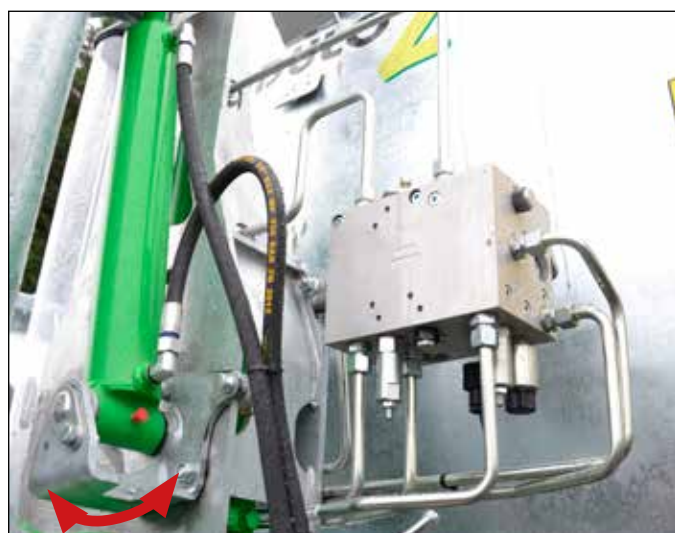
Para cambiar de lado basta con desplazar la base del cilindro de la derecha hacia la izquierda
