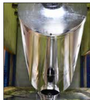
Galvanización en caliente (interior y exterior)
