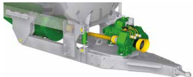
Accionamiento mecánico vía caja de las 2 bombas
