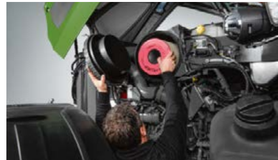
El nivel de suciedad en los filtros de aire se muestra en el terminal Vario. El compartimiento del motor es muy accesible, con paneles laterales extraíbles.
