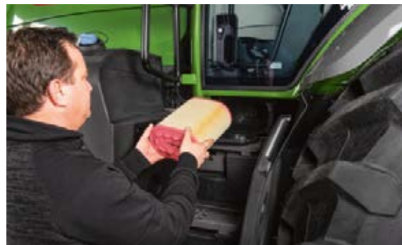
El filtro de la cabina es fácilmente accesible desde la zona de la entrada y puede limpiarse con rapidez en caso necesario.
