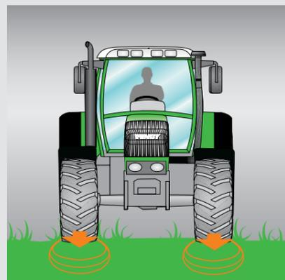
El 300 Vario puede equiparse con neumáticos muy anchos para labores de arado y pastos, lo que tiene por objeto reducir a un mínimo el daño al suelo y, en definitiva, aumentar al máximo el rendimiento.
