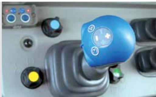
El cargador frontal se controla de forma precisa con la palanca monomando en cruz a través de dos válvulas de control. Además, un 3er y un 4º circuito hidráulico controlan el bloqueo de herramientas hidráulicas y el sistema de amortiguación.
