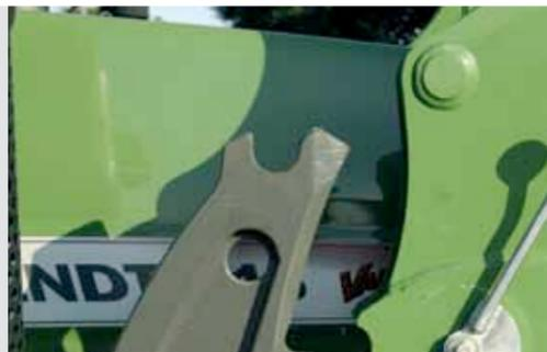
El bloqueo del Fendt CARGO permite montar y desmontar el cargador frontal rápidamente. Con el bloqueo semiautomático, no necesita utilizar pasadores de bloqueo y el cargador frontal queda bloqueado inmediatamente después de introducirlo.
