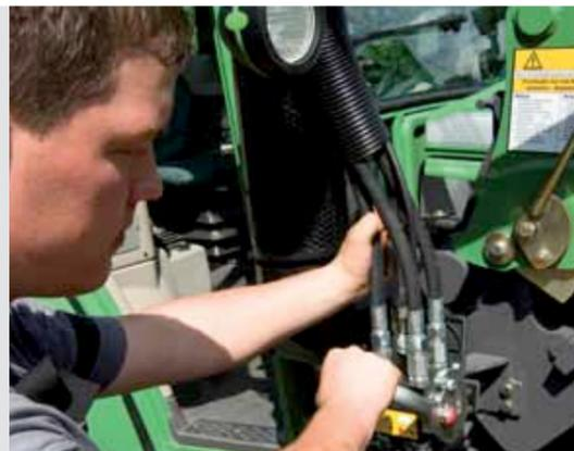
Un multiconector conecta todos los conductos hidráulicos y eléctricos al mismo tiempo, incluso con presión en el lado del cargador frontal. El cargador frontal puede montarse y desmontarse rápidamente.
