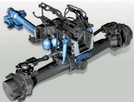
La suspensión hidroneumática opcional del eje delantero
