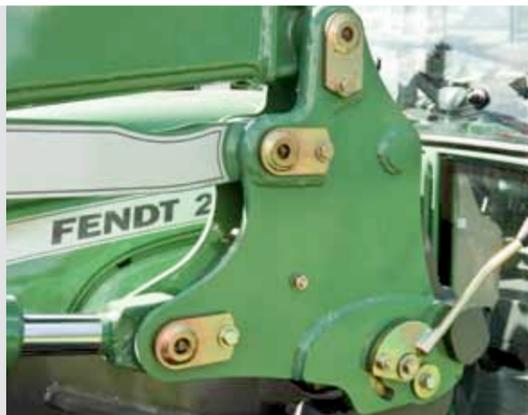
El Fendt Cargo Lock le permite montar y desmontar el cargador frontal Cargo en el 200 Vario de forma aún más rápida y con mayor facilidad. Además, el bloqueo semiautomático le ahorra tener que utilizar pernos de bloqueo, que a menudo se insertan con dificultad. Al mismo tiempo, el sistema ofrece una seguridad en el trabajo óptima, ya que el cargador delantero se bloquea de inmediato tras la entrada.
