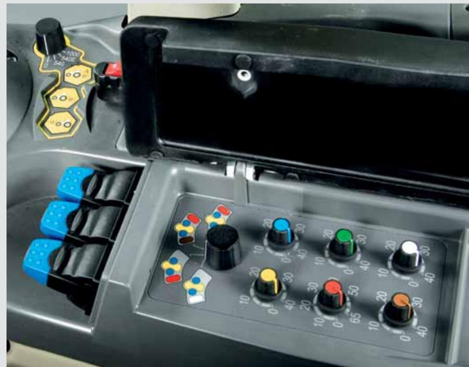
El reposabrazos se pliega para dejar a la vista un mando giratorio que selecciona la asignación de los pulsadores del joystick multifunción. La regulación del caudal de las válvulas individuales puede establecerse con los controles rotativos de colores.
