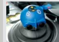
La palanca monomando en cruz permite un control preciso de la primera y la segunda válvula. El tercer y el cuarto circuito hidráulico se controlan con los pulsadores de la palanca monomando en cruz.
