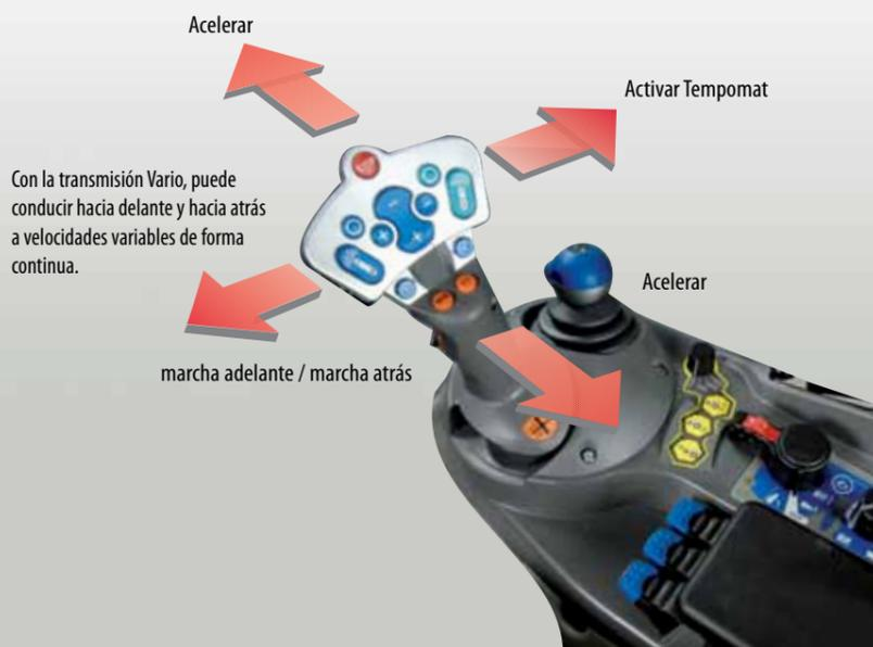
Con la transmisión Vario, puede conducir hacia delante y hacia atrás a velocidades variables de forma continua.
