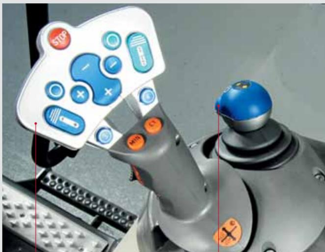
Joystick multifunción con pulsadores para el elevador trasero, las válvulas de control, el control de cruce y la memoria de revoluciones del motor
