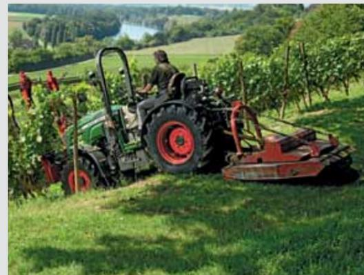
**Versión con parte superior abierta y bastidor de seguridad**
