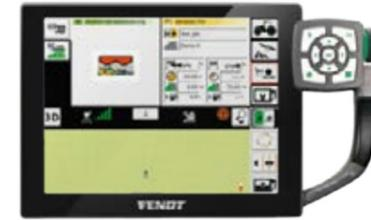
VarioDoc permite la transferencia inalámbrica de datos desde el Varioterminal hasta la base de datos específica. VarioDoc Pro registra de forma continua la posición y los datos de la máquina para enviar los datos a través de una red móvil.
