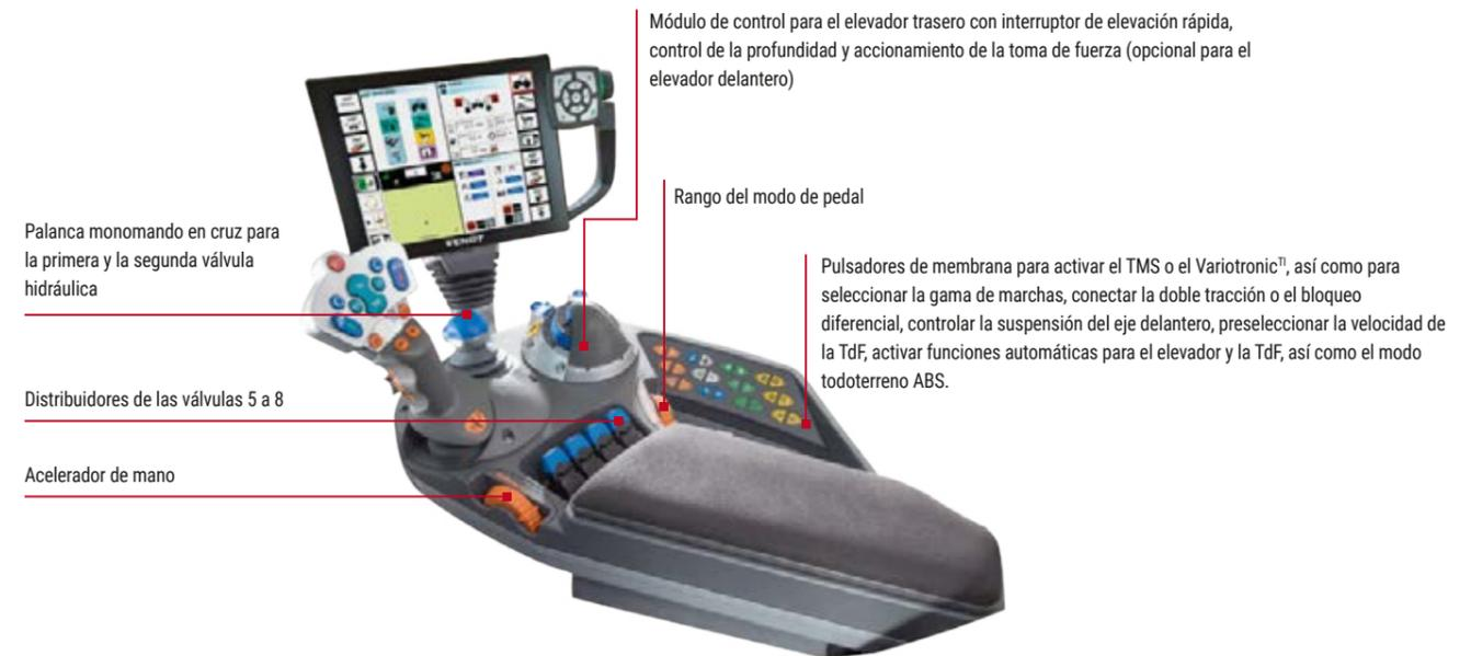
Palanca monomando en cruz para la primera y la segunda válvula hidráulica
