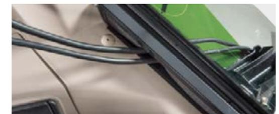
■ Fendt ofrece una solución inteligente para los cables que se extienden desde la parte trasera del tractor hasta el interior de la cabina. Los cables pueden tenderse perfectamente a través de la guía con independencia de la sección transversal. La luneta trasera puede cerrarse para que no entre polvo, suciedad, agua ni ruidos.
