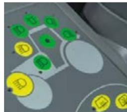
■ La iluminación se ajusta con facilidad gracias a su sencillo diseño. Con el sistema de un solo botón, puede encender todos los faros de trabajo de una vez pulsando un botón en el teclado.
