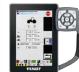
Utilizando el Varioterminal, la presión de los neumáticos del tractor puede controlarse con tan sólo pulsar un botón. El sistema de asistencia indica al conductor si la presión de los neumáticos es demasiado alta o demasiado baja.
