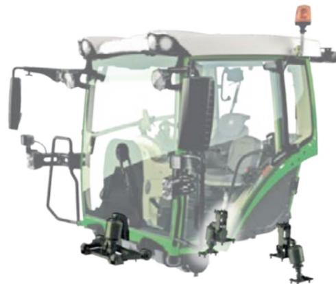
□ La suspensión de la cabina con elementos de resorte neumático permite disfrutar de una cabina en la que las vibraciones están reducidas al mínimo. La enorme diferencia en cuanto a altura y la larga distancia entre los elementos de resorte de la cabina x5 también evitan los balanceos y garantizan una máxima comodidad durante la conducción.
