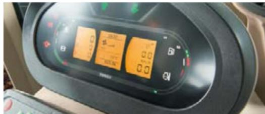
■ La iluminación interior del Fendt 800 Vario está perfectamente diseñada para alumbrar las principales zonas en las que trabaja. Independientemente de si es de día o de noche, los elementos de mando más importantes se retroiluminan de forma agradable. La intensidad de la retroiluminación se controla automáticamente en el Varioterminal mediante un sensor de luz en función de las condiciones de luminosidad.
