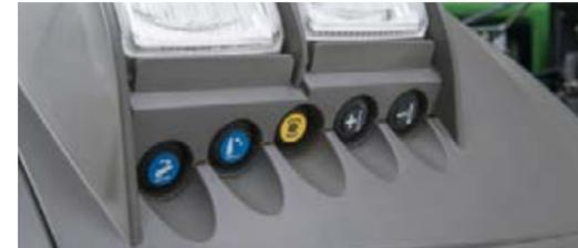
■ Los controles externos permiten accionar el elevador electrohidráulico trasero, una válvula y la toma de fuerza en el propio guardabarros trasero. Con los controles externos para la TdF trasera es posible aplicar automáticamente un régimen de motor predeterminado. Se ahorrará tareas innecesarias como, por ejemplo, al rellenar el depósito de estiércol.
