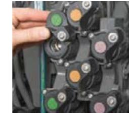
□ Los acoplamientos bajo presión (DUDK) bilaterales facilitan enormemente el montaje y el desmontaje de los aperos. Las aletas de válvula con cierre automático ofrecen una protección eficaz frente a la contaminación y permiten conectar una línea hidráulica con una sola mano.
