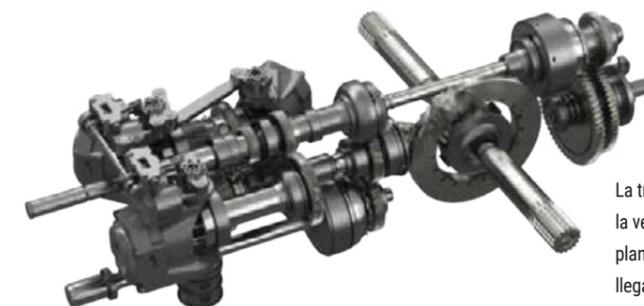
La transmisión Fendt Vario es una transmisión hidrostática-mecánica. Cuando se aumenta la velocidad, la parte de la potencia mecánica que se transmite a través del conjunto planetario aumenta. Las unidades hidráulicas pueden oscilar hasta 45 grados y pueden llegar a trabajar a una alta presión de funcionamiento de hasta 550 bar, lo que garantiza una eficacia excepcional.
