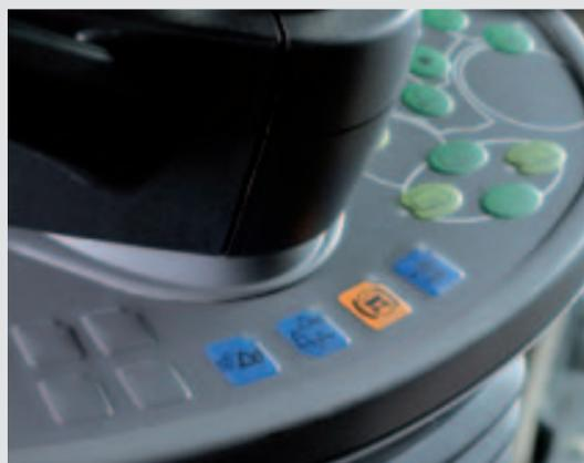
Pulsadores de membrana para el bloqueo hidráulico de accesorios y para activar el sistema de amortiguación
